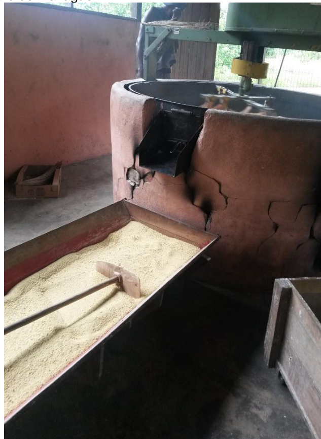
Figura 3 - Forno elétrico utilizado no processo de produção de farinha, em casa de farinha familiar, semi mecanizada, no município de Mazagão-AP.
