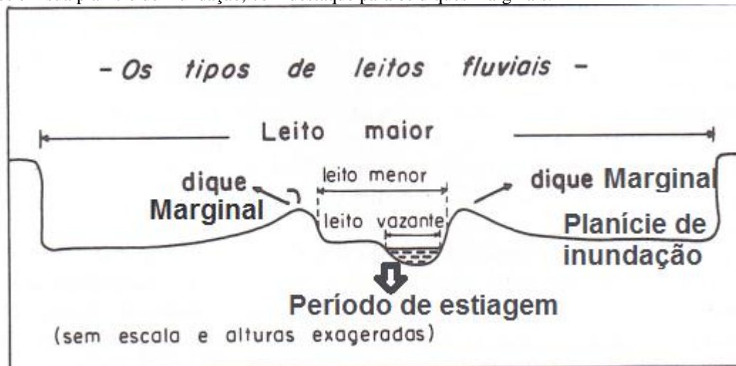
Figura 3.1. Tipos de leito. Relações existentes entre os diversos tipos de leito: maior, menor e de vazante, dispostos em sua planície de inundação, com destaque para os diques marginais.
