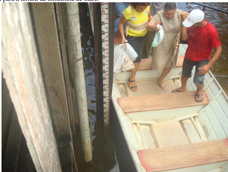
Figura 4.1: Régua utilizada pela CEDEC/AP para realizar o monitoramento do nível do rio Jari. A mesma utilizada para a leitura da influência de maré.
