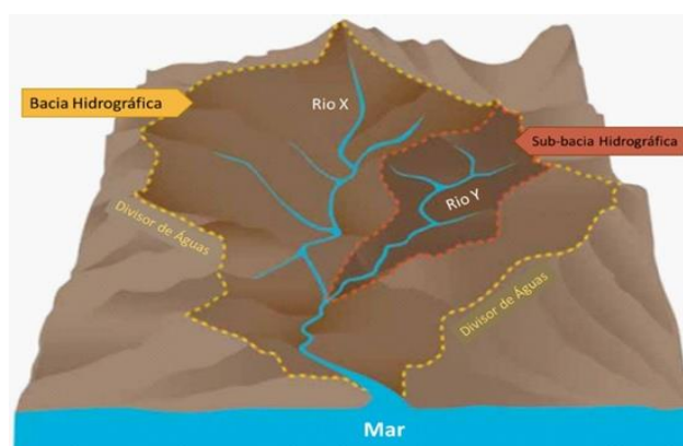
Figura 3- Componentes de uma bacia hidrográfica com a distribuição espacial entre a bacia principal e uma sub-bacia.
