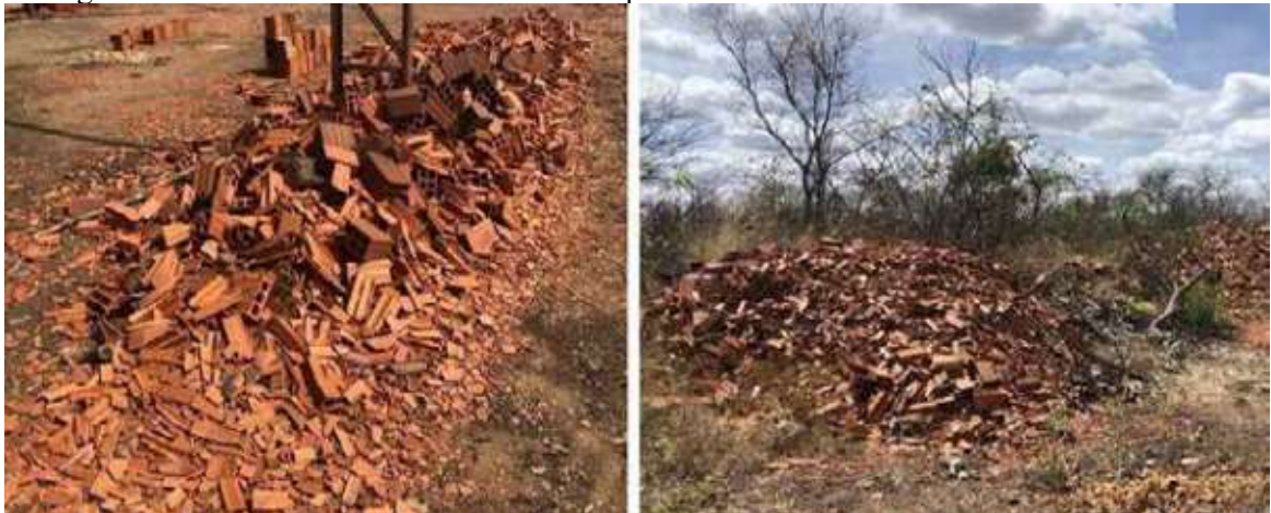
Fotografia 5 - Resíduos de blocos cerâmicos depositados a céu aberto
