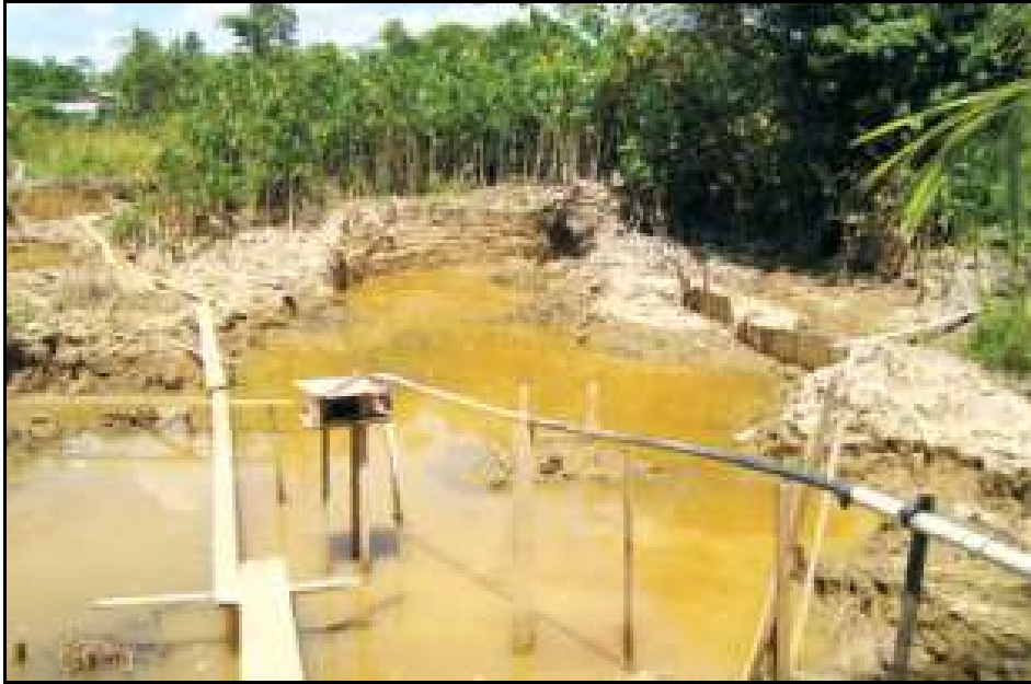
Fotografia 3 – Área de extração manual de argila
