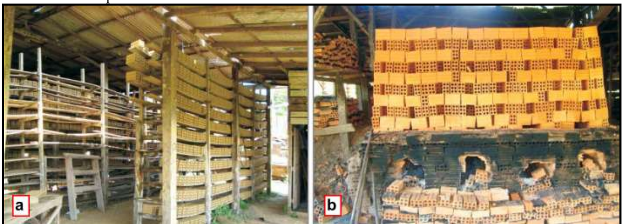
Fotografia 1 – Problemas na produção oleiro-cerâmica. a) secagem natural; b) forno pouco eficiente tipo caieira
