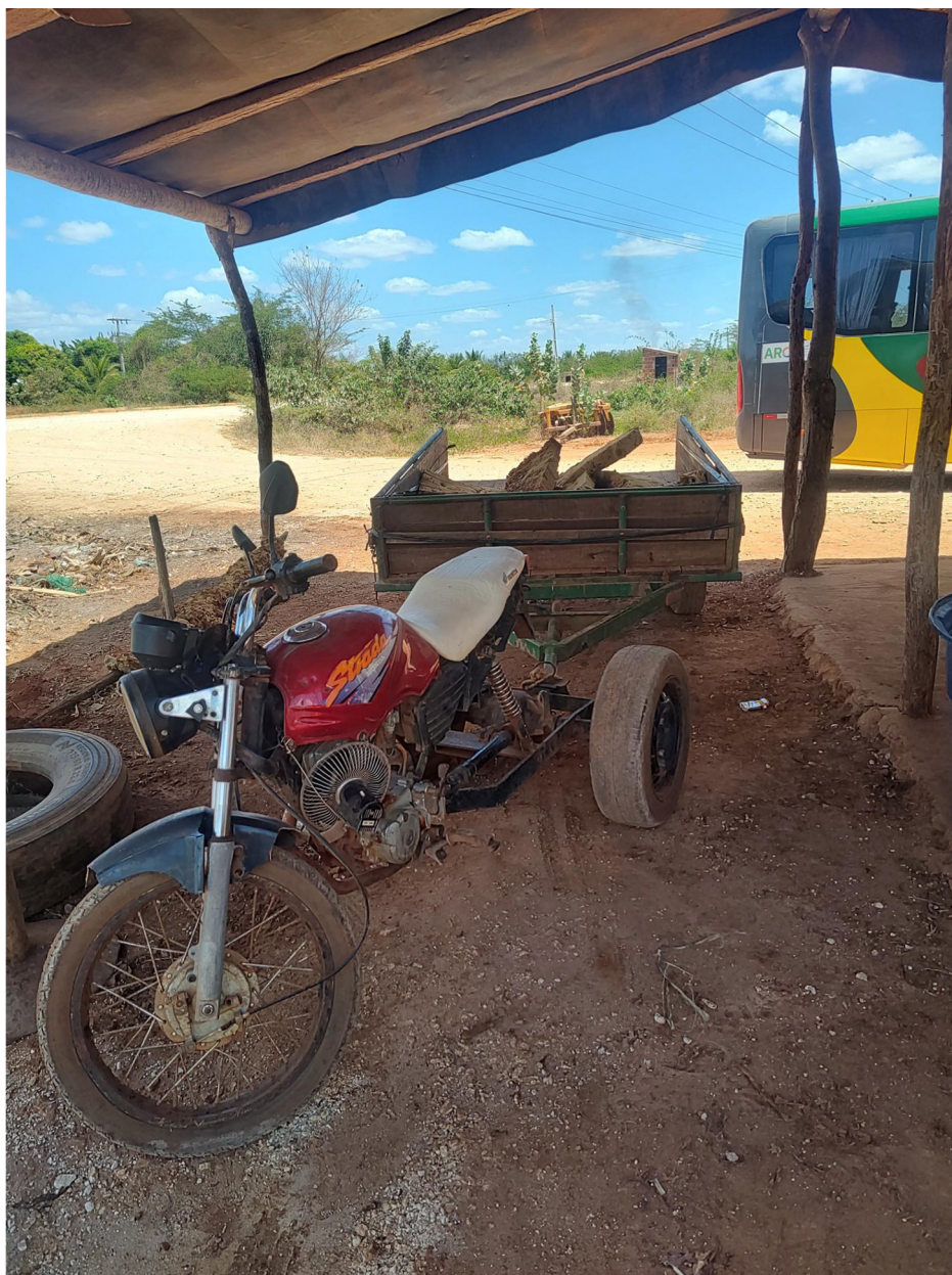
Figura 4 - Adaptação de motociclo feita na Comunidade para transporte da banana
