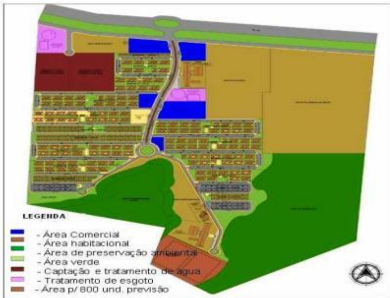
Figura 2. Implantação geral do Conjunto Macapaba - Projeto urbano
