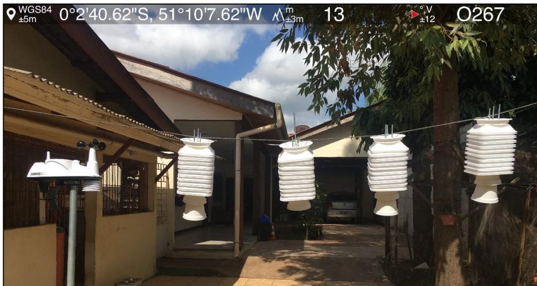
Figura 48 – Validação dos abrigos antes de instalar no Centro Comercial tendo como referência a estação Davis. Utilização do modelo 1 e intervalo de integralização de 1 minuto.
