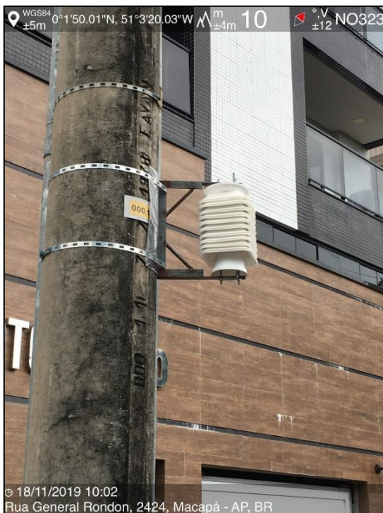
Figura 53 – Equipamento instalado no ponto P1 em frente a Praça Floriano Peixoto. (a) Abrigo meteorológico de baixo custo com o datalogger Hobo MX2301; (b) Imagem do abrigo (destaque) orientado para o Norte; e c) Imagem do abrigo (destaque) orientado para o Sudeste.
