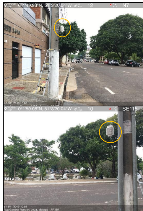
Figura 53 – Equipamento instalado no ponto P1 em frente a Praça Floriano Peixoto. (a) Abrigo meteorológico de baixo custo com o datalogger Hobo MX2301; (b) Imagem do abrigo (destaque) orientado para o Norte; e c) Imagem do abrigo (destaque) orientado para o Sudeste.
