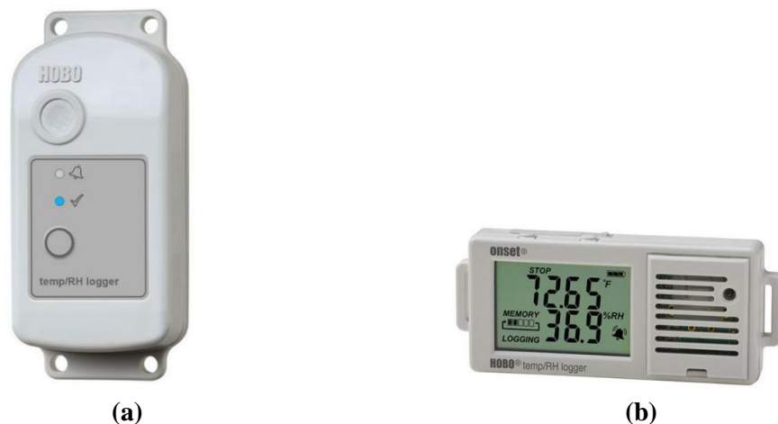
Figura 34 – Equipamentos produzidos pela ONSET utilizados nas medições de temperatura e umidade relativa do ar no meio intraurbano, sendo: (a) HOBO MX2301 e (b) HOBO UX100-003.
