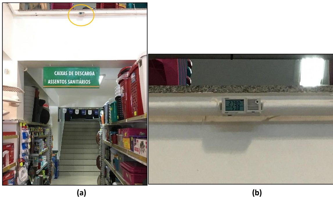
Figura 57 – Equipamento datalogger Hobo UX100-003 instalado no vão do pé-direito duplo da Loja Monte & Cia de frente para a entrada. (a) Vista do corredor com o datalogger acima e (b) Datalogger em destaque instalado no eletroduto aparente.
