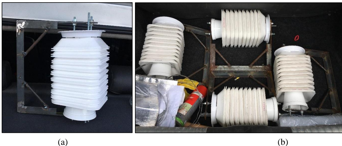
Figura 122 – Abrigos meteorológicos usados na pesquisa de campo. (a) Antes da instalação no dia 18/10/2019 e (b) Após sua retirada no dia 18/11/2019
