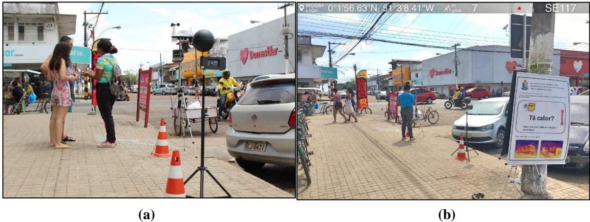
Figura 108 – Estação Davis Vantage Vue e Medidos de Estresse Térmico PROTEMP 4 instalados no ponto P3 para as entrevistas. (a) Entrevista em curso e (b) Registrando valores.
